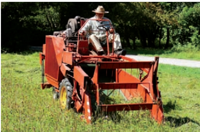
Wiesendruschernte mit Mährescher, 24.8.2009. [7] On-site threshing with small thresher, 24/8/2009.
